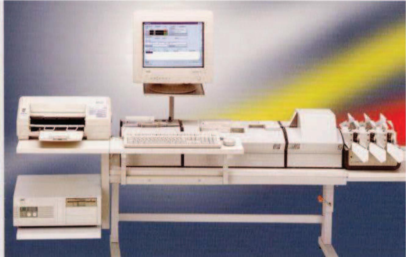
Mit dem Schecklesegerät werden die eingehenden Schecks optisch gelesen. Fehlende Daten und Hinweise für die weitere Bearbeitung werden bei diesem Arbeitsgang zusätzlich erfasst. Die Schecks werden je nach Art in verschiedenen Fächern abgelegt. Schecks unter 2.500 Euro werden nicht mehr der Bank vorgelegt, sondern werden auf elektronischem Weg der Bank zugeleitet.
