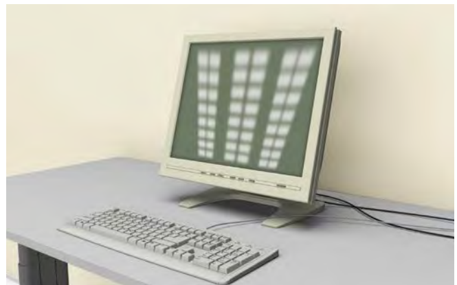
Abb. 41 Helle Flächen – zum Beispiel von Fenstern, Leuchten oder anderen Flächen mit hohen Leuchtdichten, die sich im Bildschirm spiegeln
